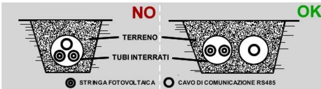
Il non rispetto di queste indicazioni potrebbe causare gravi danni alla SunGuard Box, agli inverter e agli apparati al quel il cavo è connesso a causa di elevati disturbi sulla comunicazione.
